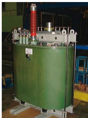
鉄道総合技術研究所との共同研究により試作した新幹線車両用超伝導変圧器
