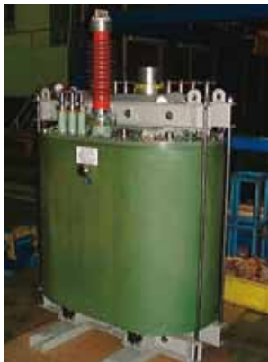
財団法人鉄道総合技術研究所との共同研究により試作した新幹線車両用超伝導変圧器
