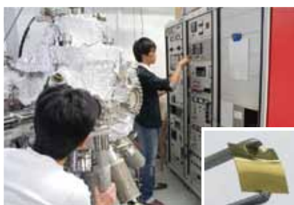
分子線エピタキシー装置を使った実験風景 (挿入図：フレキシブル基板上に形成した次世代半導体結晶)
